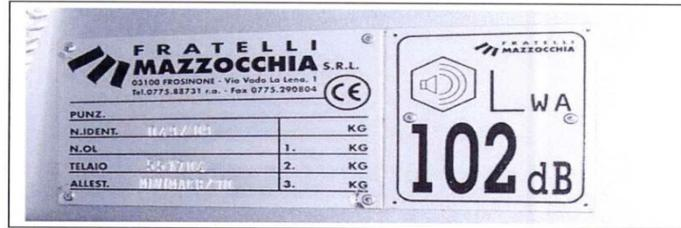
Le misurazioni relative alle emissioni acustiche rilevate in corrispondenza delle postazioni di operatori sono effettuate in accordo alla EN 1501-4:2007. Il livello di **potenza sonora garantito** per l'attrezzatura è riportato sulla targhetta presente sul veicolo mostrato, a titolo di esempio, in foto.
