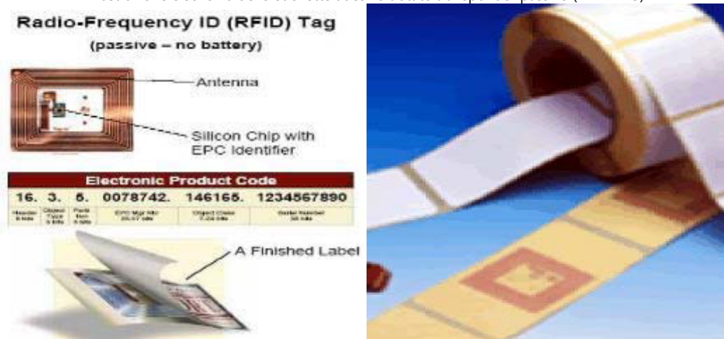
Illustrazione e schema delle etichette adesive dotate transponder passivo (RFID TAG)
