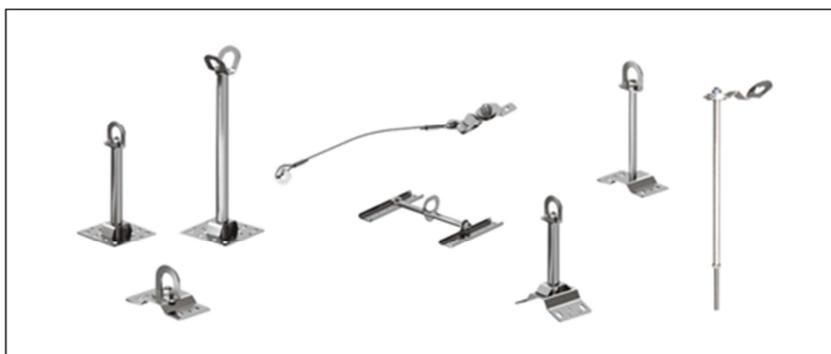
**Ancoraggio di Tipo C** - ancoraggio lineare (ancoraggio flessibile): dispositivo di ancoraggio che utilizza una linea di ancoraggio flessibile che devia dall'orizzontale non più di 15° (quando misurata tra l'estremità e gli ancoraggi intermedi a qualsiasi punto lungo la sua lunghezza);
